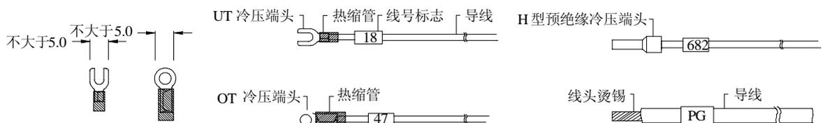
图 6-8 PLC 连接电缆制备方式推荐
