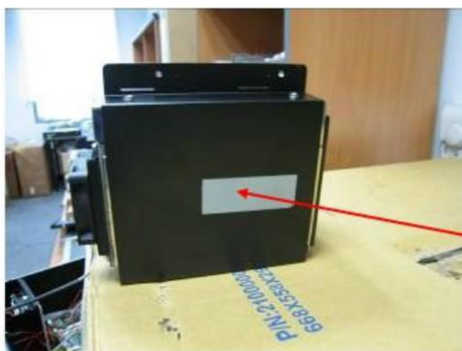
硬盘托 架底部 特别留 出金属 层，与底 板弹片 接触，使 得托架 和机箱 接地。
